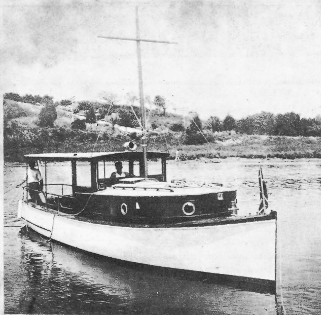
Crucero "MARIOLGA", del señor Roberto Martínez; 33 pies de eslora, 8'8" de manga y 5'10" de puntal, construido en los Astilleros ALMENDARES.
